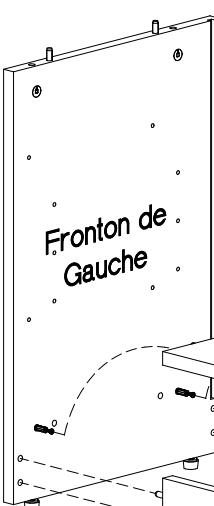
8. Pour verrouiller, tourner les vis de cam dans le sens des aiguilles de la montre
