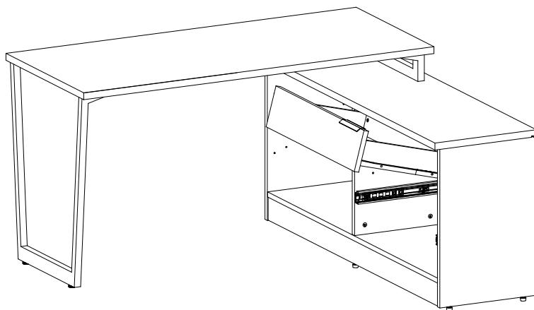
2. Fixer le montant de métal pour plan de travail au piédestal avec les boulons JCBC, M6 x 40 mm et les rondelles fournis.
