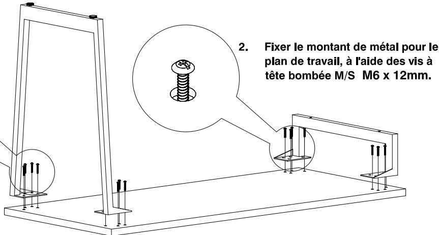
2. Fixer le montant de métal pour le plan de travail, à l'aide des vis à tête bombée M/S M6 x 12mm.
